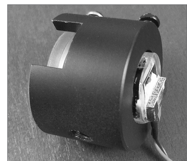
Р и с . 14. Загальний вигляд детектора Hamamatsu S6968-01 в картриджі з лінзою #L002: а – картридж для L_D = 1,0 мм; б – картридж зі змінним фокусом L_D = 7-25 мм; в – картридж для L_D = 10 мм
