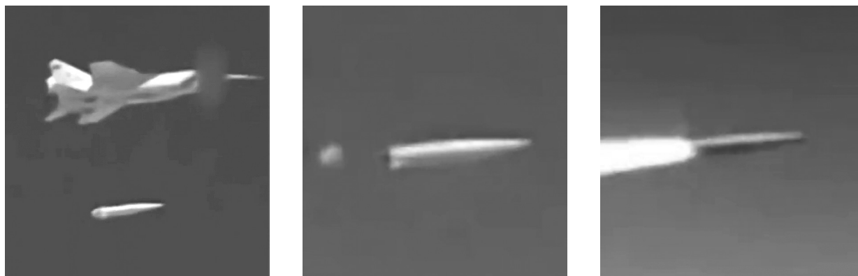
Рис. 2. Відстріл захисного обтічника двигуна та запуск двигуна
