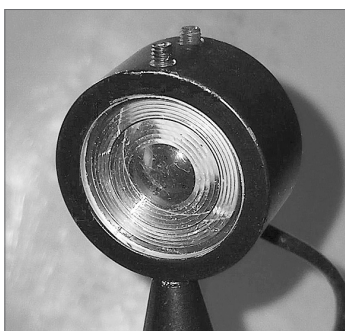
Р и с . 14. Загальний вигляд детектора Hamamatsu S6968-01 в картриджі з лінзою #L002: а – картридж для L_D = 1,0 мм; б – картридж зі змінним фокусом L_D = 7-25 мм; в – картридж для L_D = 10 мм
