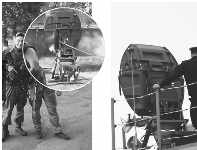
Фото 3. Зовнішній вигляд антени станції «Аурига»
