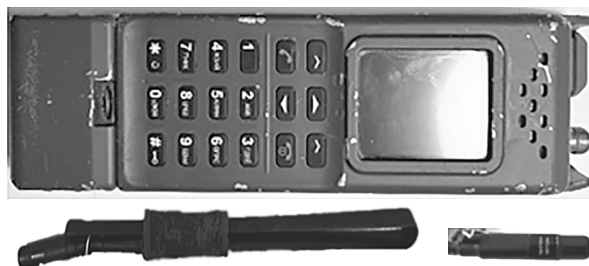
Фото 4. Загальний вигляд російської радіостанції в розібраному стані
