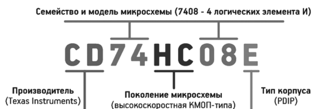
Рис. 3. Маркування мікросхеми CD74HC08E
