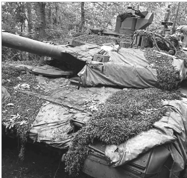
Рис. 4. Трофейний танк Т-90М «Прорив» зі спеціальним маскувальним комплектом «Накидка» (фото з відкритих джерел)
