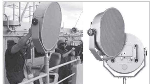
Рис. 4. Спрямовані акустичні випромінювачі великої потужності (LRAD)
