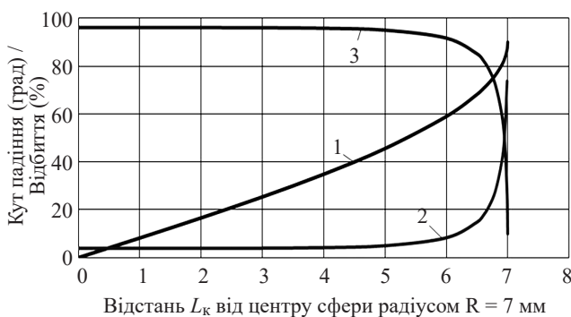
Рис. 2. Відбиття світла від поверхні сфери радіусом R_L = 7,0 мм: 1 – кут відбиття (град), 2 – коефіцієнт відбиття (%); 3 – коефіцієнт пропускання (%)
