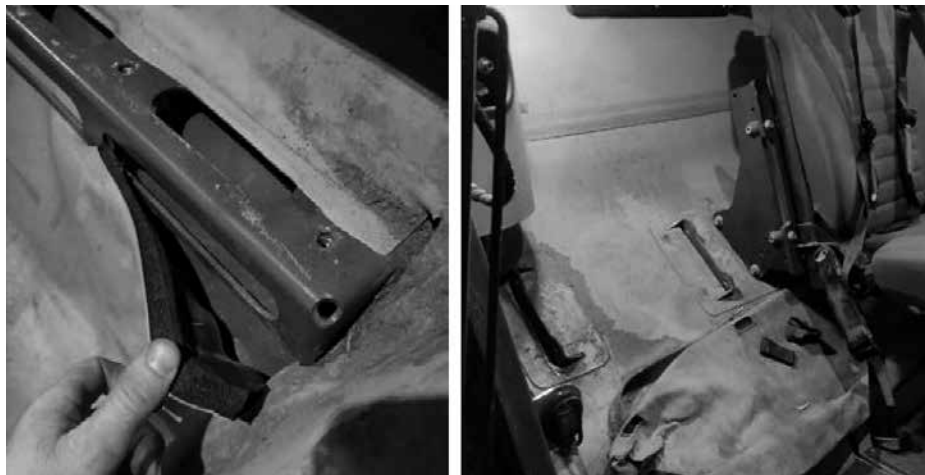
Рис. 25. Протиосколковий підбій «Тайфун-К»
