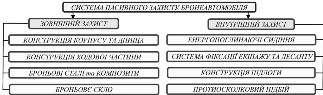
Рис. 2. Система пасивного захисту броневаномобіля КамАЗ-63968 «Тайфун-К»
