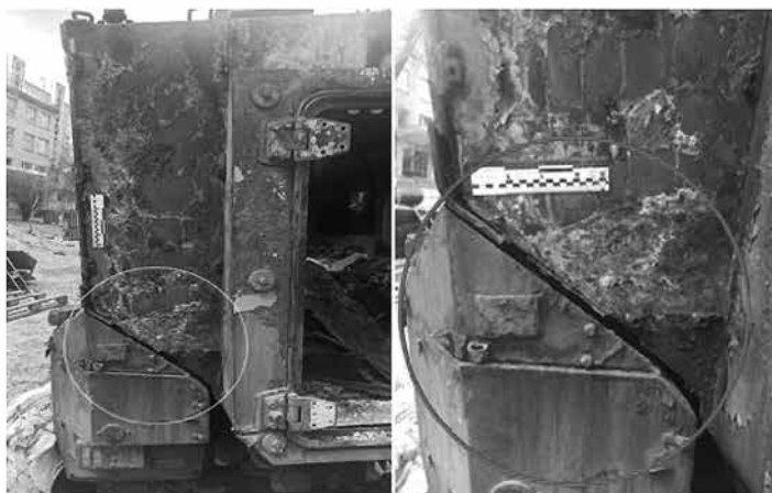
а) скоси на днищі десантного модуля «Тайфун-К»
