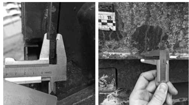
Рис. 17. Третій затримуючий шар броньованої сталі дисперсно-керамічної броні
