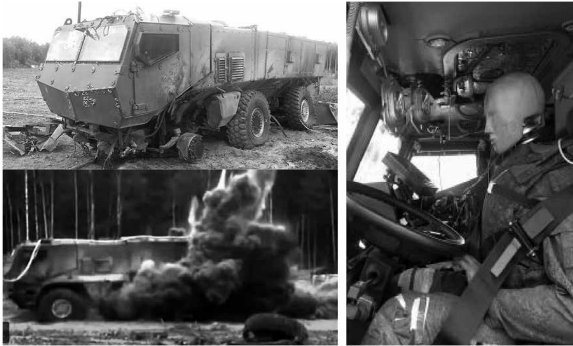
Рис. 9. Натурні випробування підривом на заряді 6 кг у тротиловому еквівалент
