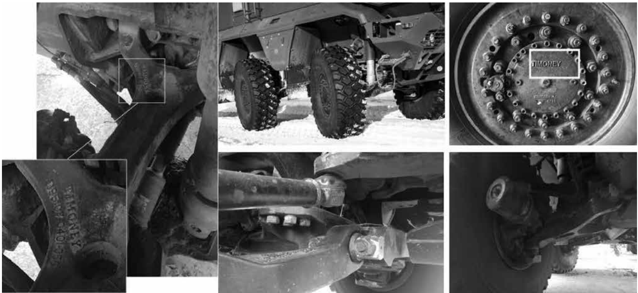
Рис. 12. Елементи гідропневматичної підвіски Timoney Technology Limited на «Тайфун-К»
