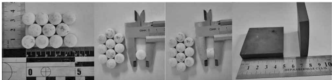
Рис. 15. Керамічні елементи бронювання КамАЗ-63968 «Тайфун-К»
