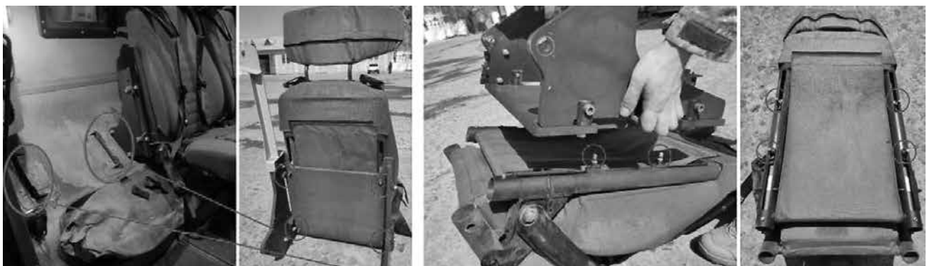
Рис. 21. Спосіб кріплення сидіння КамАЗ-63968 «Тайфун-К»
