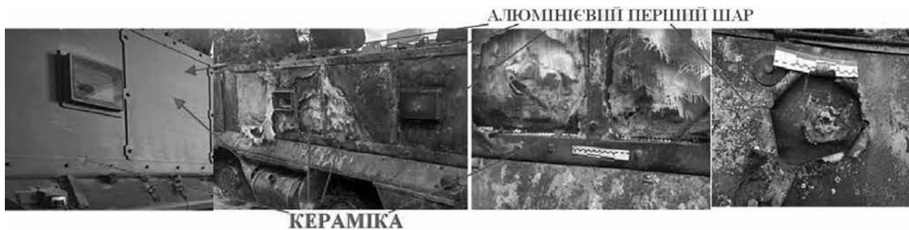
Рис. 14. Додаткова дисперсно-керамічна броня «Тайфун-К»
