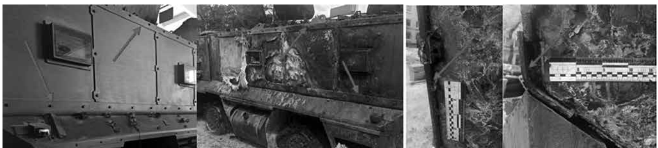
Рис. 10. Перекриття з'єднань елементів корпусу
