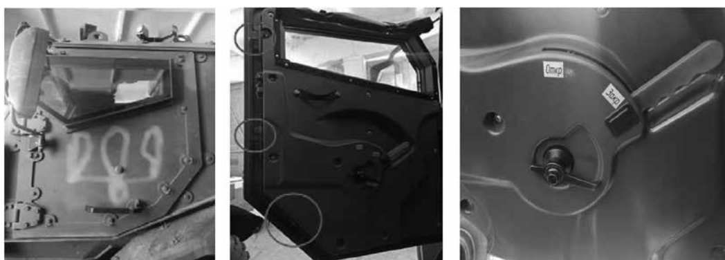
Рис. 11. Триточкові механізми замикання дверей кабіни «Тайфун-К»
