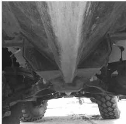
б) V-подібний протимінний екран
