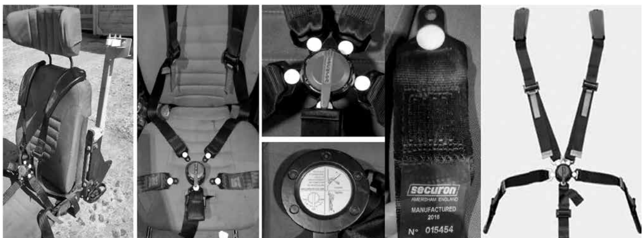
Рис. 23. Система фіксації екіпажу та десанту «Тайфун-К»
