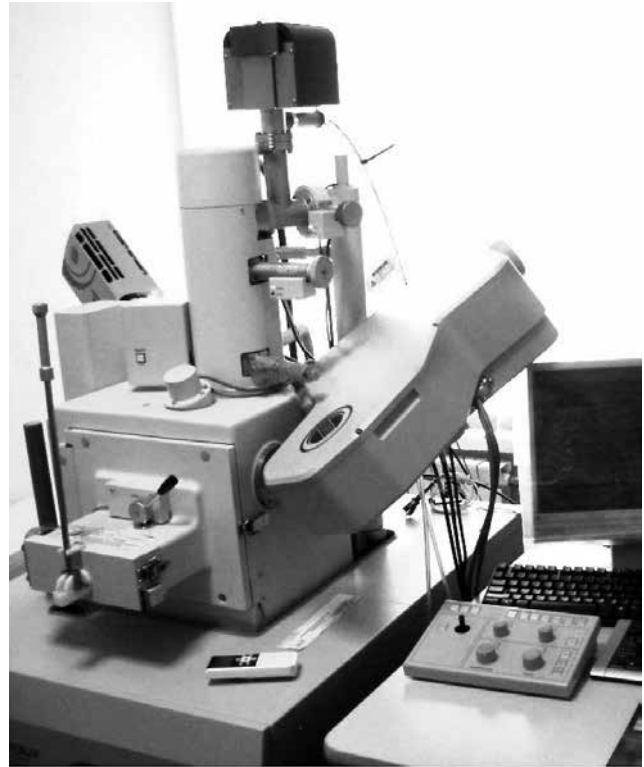
Рис. 1. Скануючий електронний мікроскоп JSM-6490LV, JEOL Ltd, Японія
