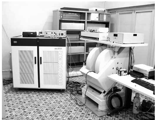
Рис. 12. Фур'є ЕПП спектрометр ELEXIS SERIA E 580-10/12, Bruker
