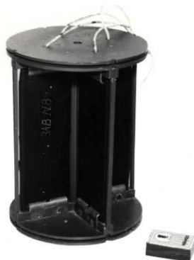
Рис. 13. Зразки конструкцій векторних приймачів силового типу
