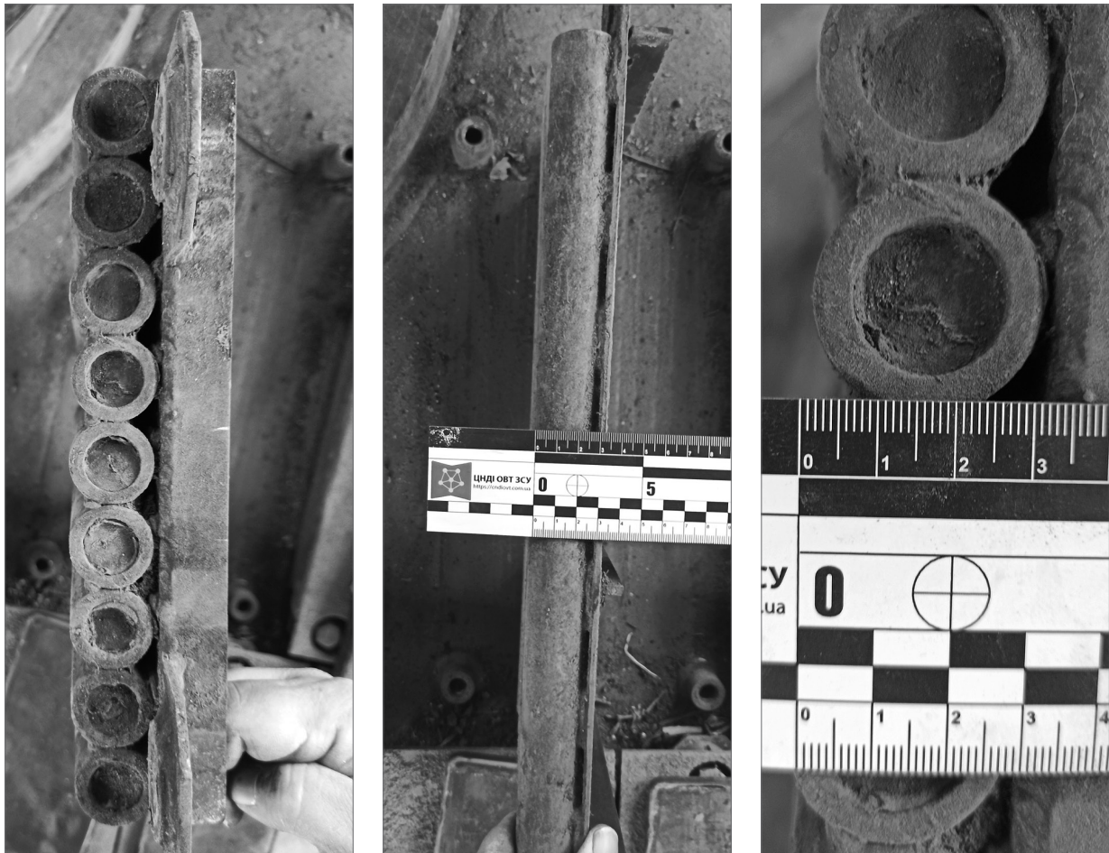
Р и с . 3. Зовнішній вигляд та геометричні розміри трубчатих демпферів (фото трофейного зразка)
