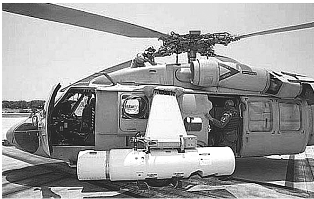
Рис. 2. Підвісна лазерна система виявлення мін ALMDS
