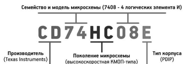
Рис. 3. Маркування мікросхеми CD74HC08E
