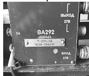
Фото 7. Маркування складових частин виробу Т-231-2А
