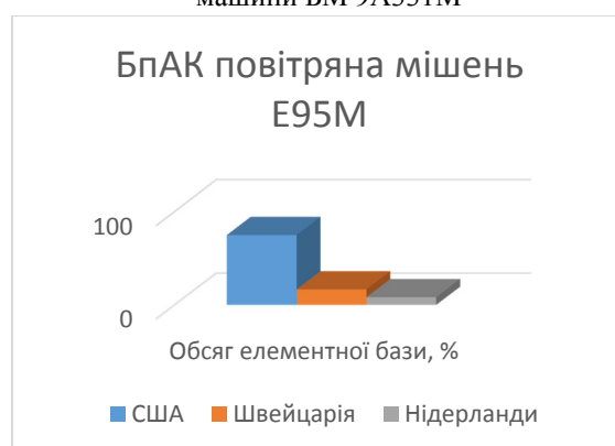
Рис. 8. Розподіл частоти використання елементної бази іноземного виробництва в уламках БпАК повітряна мішень Е95М
