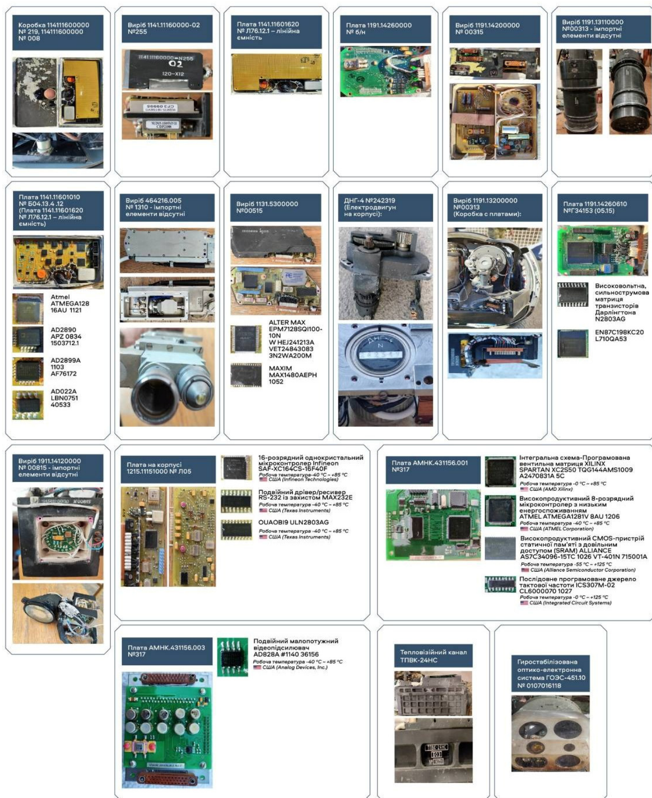
Рис. 4. Топологія елементної бази уламків розвідувально-ударного вертольоту КА-52 «Алігатор»
