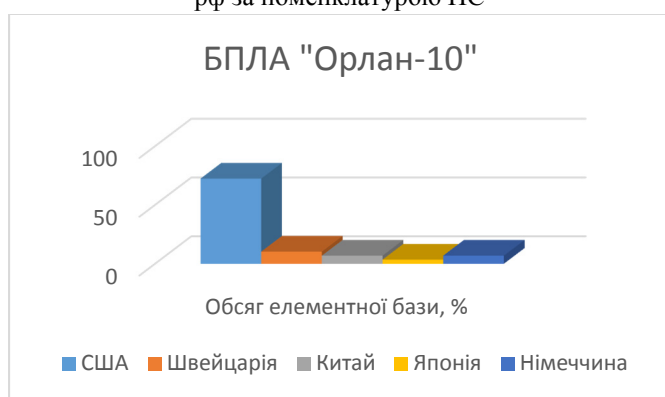
Рис. 7. Розподіл частоти використання елементної бази іноземного виробництва в уламках БПЛА «Орлан-10»
