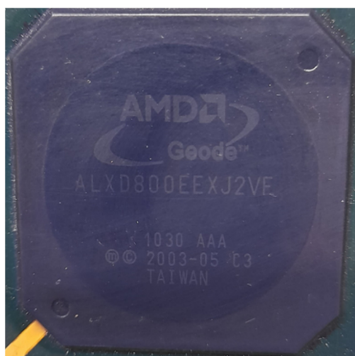
Рис. 4. Процесор AMD Geode ALXD800EEXJ2VE плати ІСАТ.687264.036 головки самонаведення АРГС-14 ракети 3М-14
