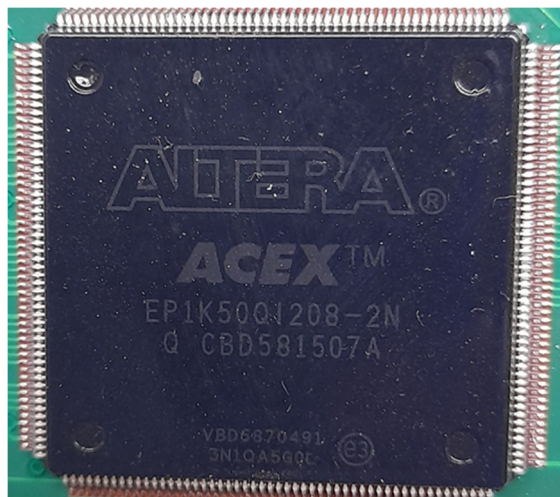
Рис. 6. Програмно-логістична інтегральна мікросхема ALTERA ACEX EP1K500J208-2N плати ІСАТ.466533.007 головки самонаведення АРС-14 ракети ЗМ-14
