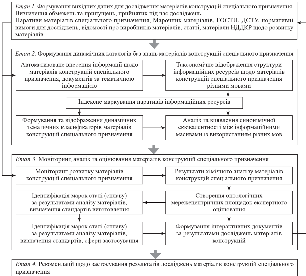
Р и с . 2. Структура науково-методичного апарату досліджень матеріалів конструкцій спеціального призначення
