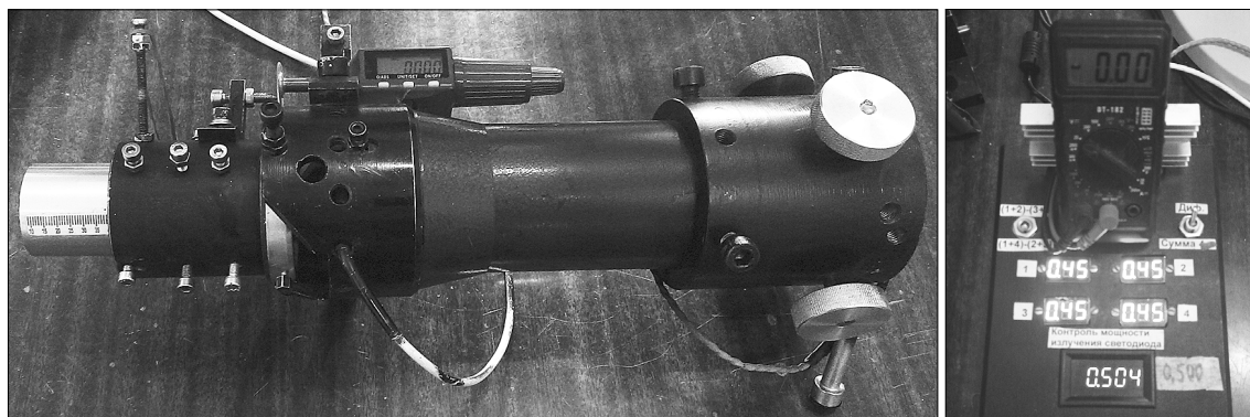
Рис. 7. Загальний вигляд стенду для дослідження пеленгаційних характеристик (а) і зображення вимірювального блоку (б) з сигналами ( D_1 – D_4 ) з чотирьох-площинного фотодетектора для нульового кута повороту \theta
