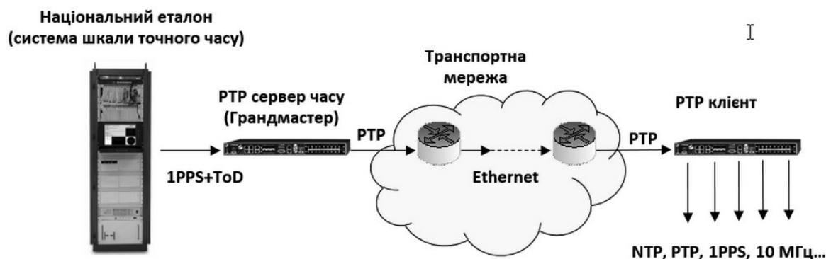
Рис. 1. Структурна схема доставки еталонних сигналів за протоколом PTP IEEE 1588v2
