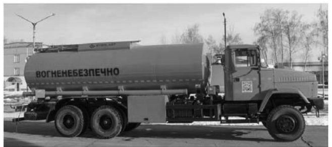
Рис. 3. Армійський паливозаправник КрАЗ-63221 з цистерною АПЦ-20
