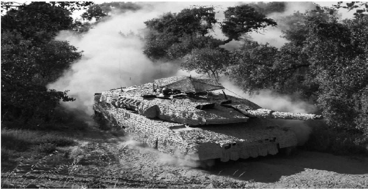
Рис. 3. Танк "Leopard 2A6" з системою маскування "Integrated Multipurpose Camouflage Systems"
