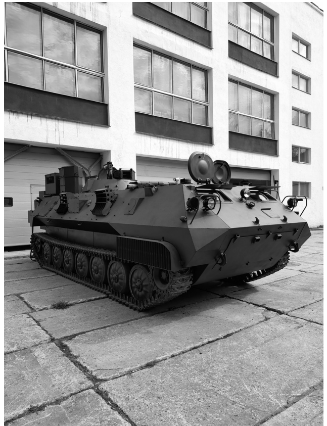
Рис. 1а. Машина командира дивізіону з системою розвідки та цілевказування в похідному режимі використання системи
