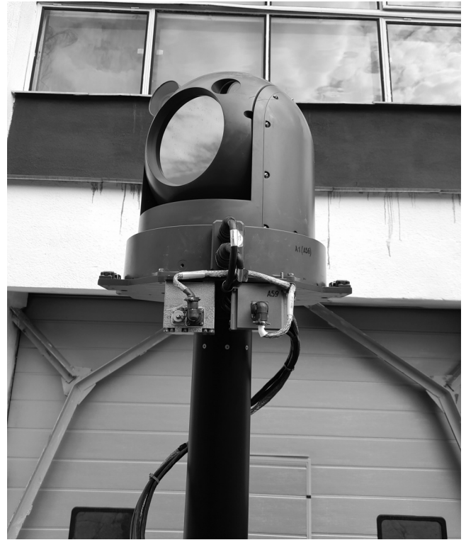
Рис. 2. Розміщення на майданчику щогли блоків твердотільного азимутального гіроскопа та вимірювача крену і тангажу
