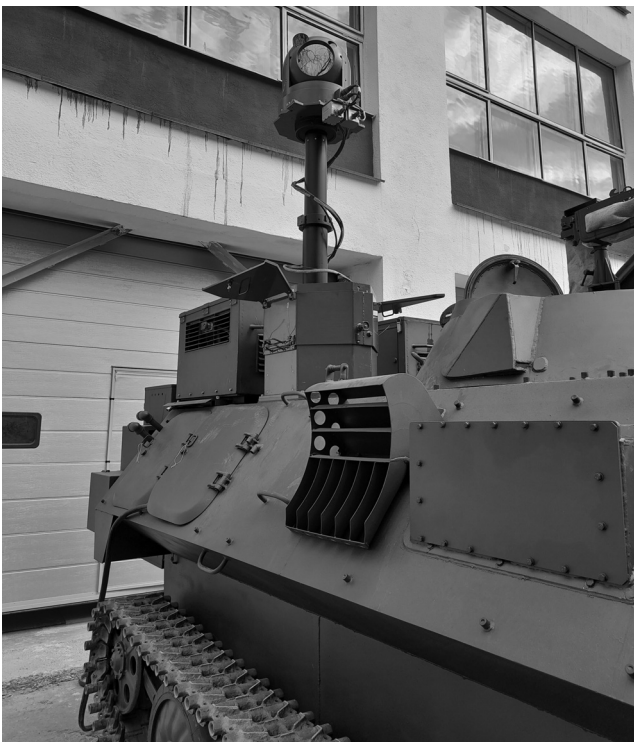
Рис. 1 в. Машина командира дивізіону з системою розвідки та цілевказування в робочому режимі з максимальною висотою спостереження
