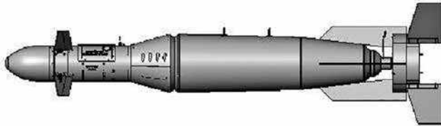
Рис.2. Схема компонування КАБ: 1 - блок БАУ-01КТ; 2 - авіабомба ФАБ-250-М54, 3 - додаткове оперення
