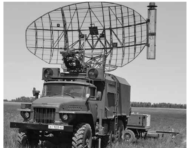
Рис. 6. РЛС “MARS-L” із суміщенням первинного та вторинного каналу в одній антені
