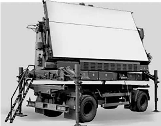
Рис. 5. РЛС 90К6 з твердотільним передавачем на транзисторних палетах на основі нітриду галію
