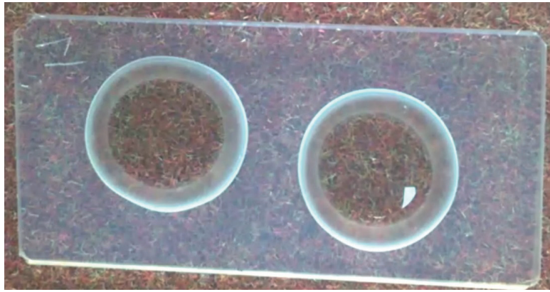
Рис. 3. Процес поглинання води світлопрозорим пористим склом, виготовленим за технологією хімічного травлення без попередньої спеціальної термічної обробки
