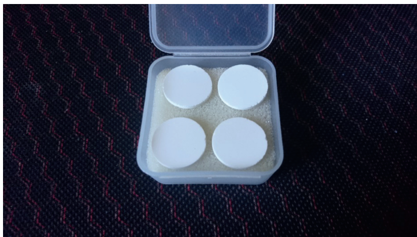
Рис. 5. Несвітлопрозоре пористе скло ПС-1-Ш з макро-порами понад 100 нм, виготовлення способом хімічного травлення заготовок ДВ-1-Ш
