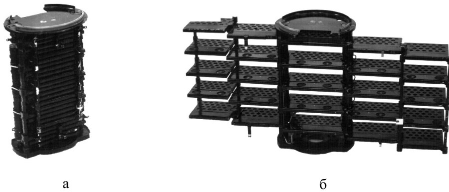
Рис. 2. Опукна гідроакустична жорсткої конструкції в її транспортному (а) та робочому (б) станах
