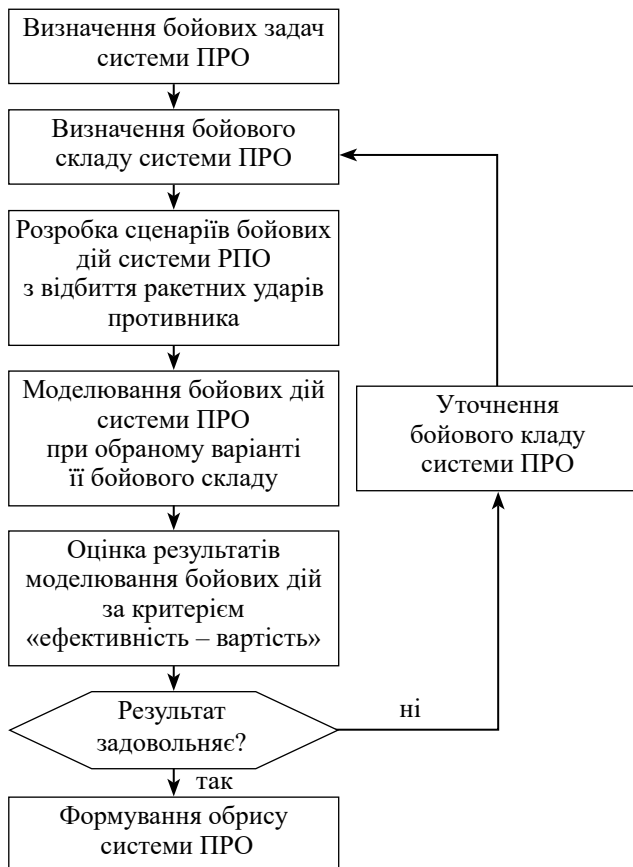
Р и с . 2. Загальний алгоритм обґрунтування обрису системи ПРО з використанням системи імітаційного математичного моделювання бойових дій
