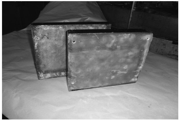
Рис. 4. Загальний вигляд ЗКЕ (габаритні розміри 241×272 мм) з дискретними керамічними елементами на стадії складання (а) та готових ЗКЕ, залитих олію-гумою (б)
